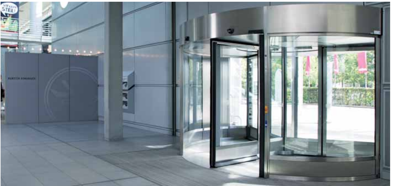
FLUGHAFEN MÜNSTER-OSNABRÜCK | GREVEN | Großraumkarusselltür GGR | vollautomatisch | 3-flügelig | edelstahlbeplankt | Flügel ausschwenkbar für Flucht- und Rettungswege | ø 4800 mm
