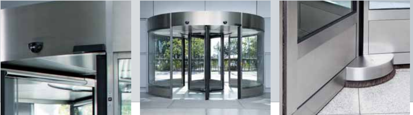
FLUGHAFEN MÜNSTER-OSNABRÜCK | GREVEN | Großraumkarusselltür GGR | vollautomatisch | 3-flügelig | edelstahlbeplankt | Flügel ausschwenkbar für Flucht- und Rettungswege | ø 4800 mm
