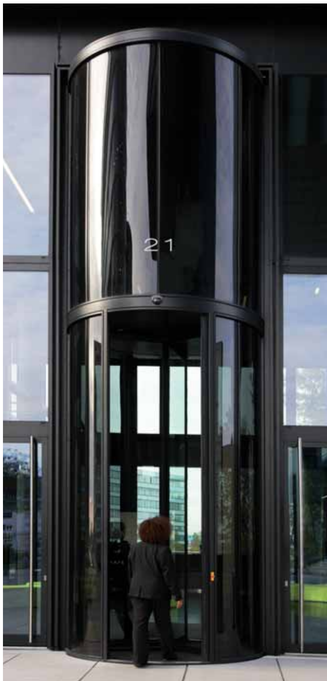
BÜROTURM HAFEN-CITY | DÜSSELDORF | J • S • K Architekten GRA in Sonderausführung | vollautomatisch | 3-flügelig | Durchmesser 2280 mm | Gesamthöhe 7860 mm
